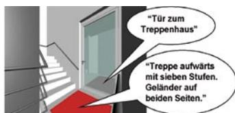
Umgebungsmodell des Blindenassistenzsystems: Zur Verbesserung der Orientierungs- und Navigationsmöglichkeiten von sensorisch Behinderten können im Umgebungsmodell erweiterte Informationen an reale und virtuelle Objekte angeheftet werden.
